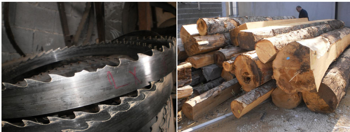
Slike 7. i 8. Oštećena pila i izdvojeni trupci na pilani
